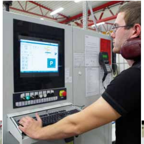
Vid våra CNC-maskiner kan flera moment utföras samtidigt; utskärning (urtag), håltagning och slipning.
