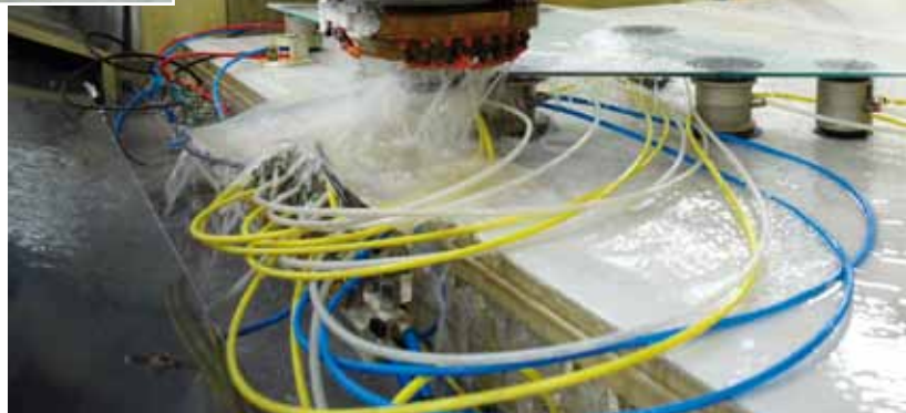
Vid våra CNC-maskiner kan flera moment utföras samtidigt; utskärning (urtag), håltagning och slipning.
