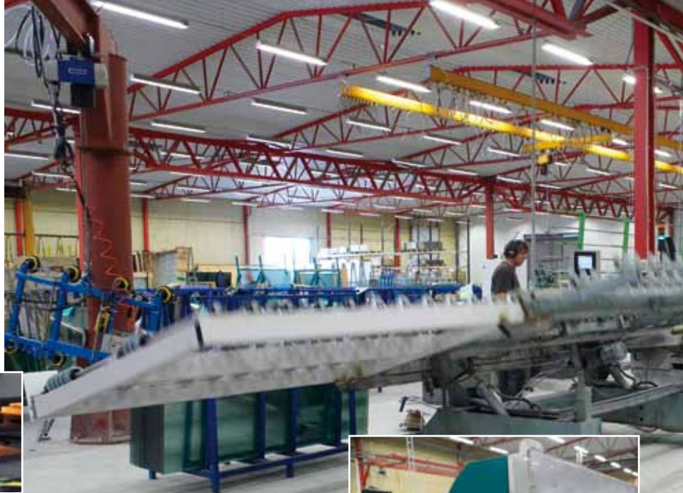
Ett steg i förädlingen är slipning, maskinen på bilden kan slipa glas som är upp till sex meter långa.
