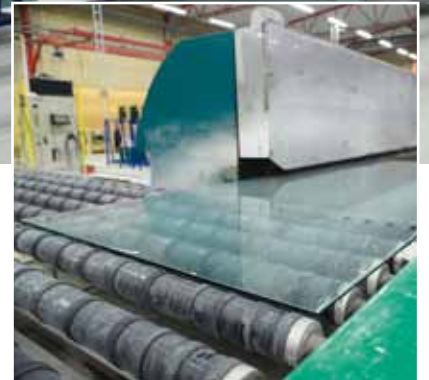
Ett steg i förädlingen är slipning, maskinen på bilden kan slipa glas som är upp till sex meter långa.
