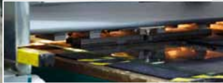
Lamellglas skärs med en specialteknik som värmer av glasets.
